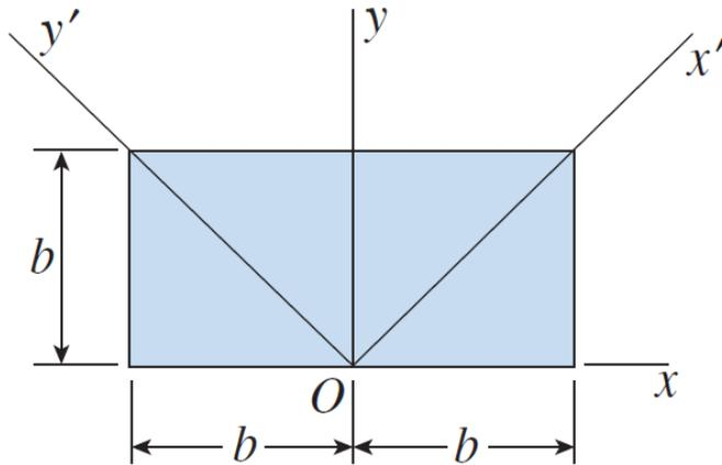
$$I_{x'} = \frac{I_x + I_y}{2} + \frac{I_x - I_y}{2} \cos 2\theta - I_{xy} \sin 2\theta$$
