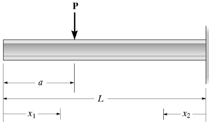
2. Determine the equation of the elastic curve for the beam using the  $x$  coordinate. Specify the slope at  $A$  and the maximum deflection.  $EI$  is constant. 【运用坐标  $x$  求图示梁的挠曲线，并求截面  $A$  的转角和梁中最大挠度及其所在截面。设弯曲刚度  $EI$  为常数。】
