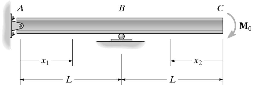
4. Determine the equations of the elastic curve using the coordinates  $x_1$  and  $x_2$ , and specify the deflection and slope at  $B$ .  $EI$  is constant. 【运用坐标  $x_1$  和  $x_2$  求图示梁的挠曲线，并求截面  $B$  的挠度和转角。设弯曲刚度  $EI$  为常数。】
